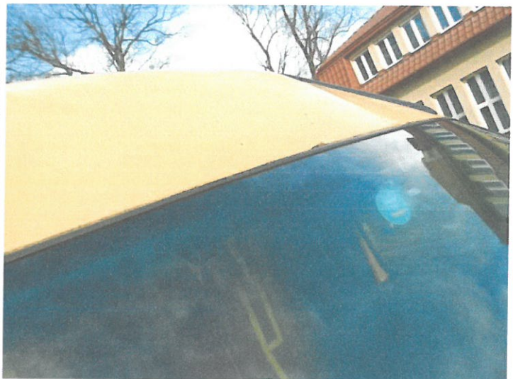
WIDOK WYKWITU KOROZJI NAD SZYBĄ CZOŁOWĄ
