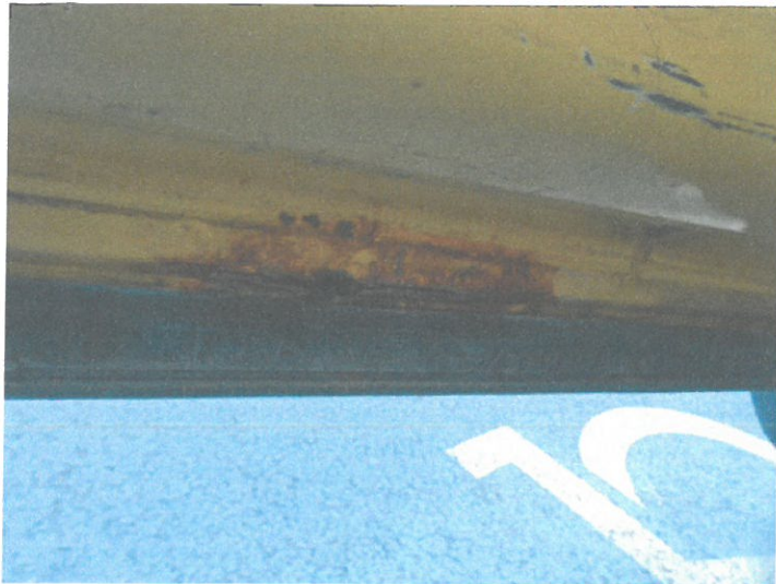
WIDOK KOROZJI NA DRZWIACH POJAZDU
